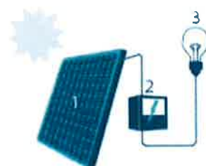
1 Zonnepaneel | 2 Omvormer 3 Elektrische toestellen
